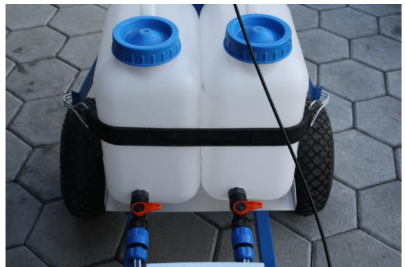
(Behälter mit Absperrhahn)
